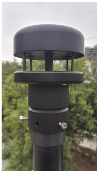
Рисунок 1 - Внешний вид анемометра ИСВ-4Е
